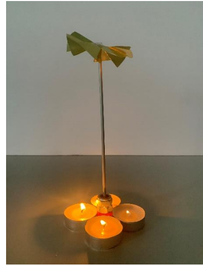
Foto 4: Forscherstation Die Stricknadel wird in der Knete befestigt, die Rotorblätter auf das obere Ende der Stricknadel gesteckt und die Kerzen werden angezündet.
